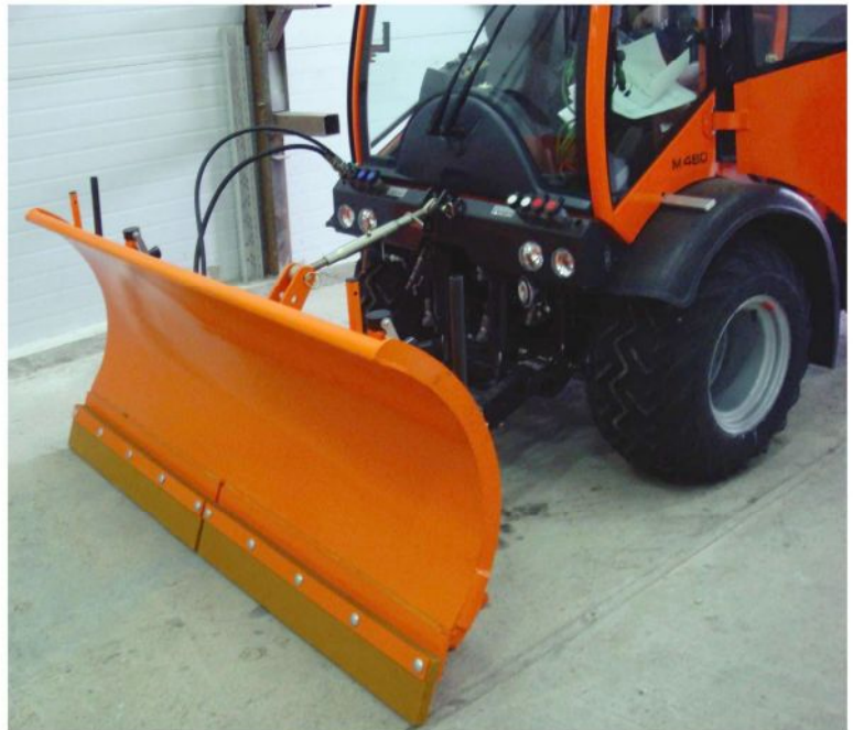
Фото 3. Плуг-отвал для снегоочистки дорожного покрытия.
