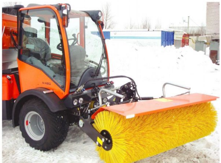
Фото 4. Цилиндрическая щетка из жесткого полипропиленового ворса.
